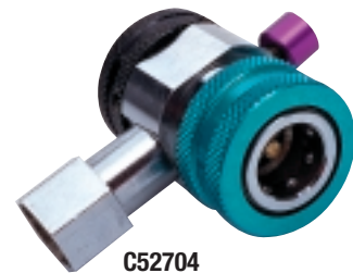
C52704 Raccord Purge-Mate côté basse pression pour R134a avec bouton de purge. Il suffit d'appuyer sur le bouton pour purger l'air.
